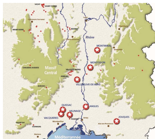
FIGURE 3. Les gisements naturels de CO 2 dans la province carbogazeuse française (grosses étoiles). Les points rouges correspondent à des eaux carbogazeuses exploitées (boissons, thermalisme). (© BRGM).
