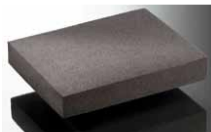
Il vetro cellulare presenta buona resistenza a condizioni atmosferiche estreme, considerata la sua natura, e buona resistenza a compressione, con un valore di densità superiore ad altri isolanti convenzionali; si presenta in forma di o in granuli pannello (es. Glapor foam glass® - Glapor, Polydros® - Röfix) (Fonte: ©Glapor).
