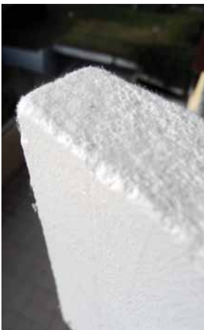
Nucleo di pannello VIP definito "supermicroporoso" costituito da cellule micronizzate di materiale inerte, polveri ceramiche a base di ossidi di silicio e ferro (Fonte: ©Aliprandi).
