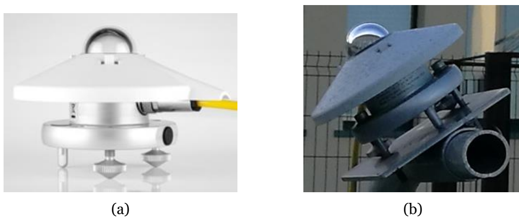
Figura 3.14 - Piranómetro CMP3: (a) em pormenor; (b) na instalação.
