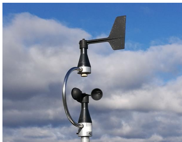
Figura 3.15 - Grupo anemómetro, cata-vento e sensor de temperatura.
