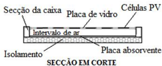
Figura 2.20 - Esboço de um coletor PVT (adaptado de [59]).
