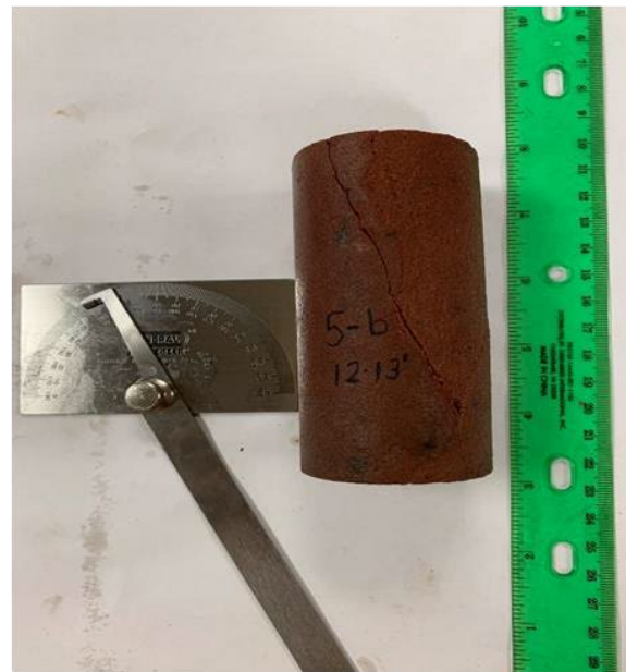
(d) Tensile failure across discontinuities
