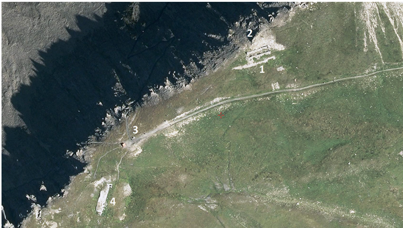
Fig. 3. Colle delle Chavannes: 1) Mont Fortin, baraccone e contenimento in opera a secco dell'area insediativa; 2) Trinceramento a salienti e rientranti del Mont Fortin; 3) Col des Chavannes; 4) Edificio novecentesco in cemento. (Elaborazione di R. Sconfienza)
