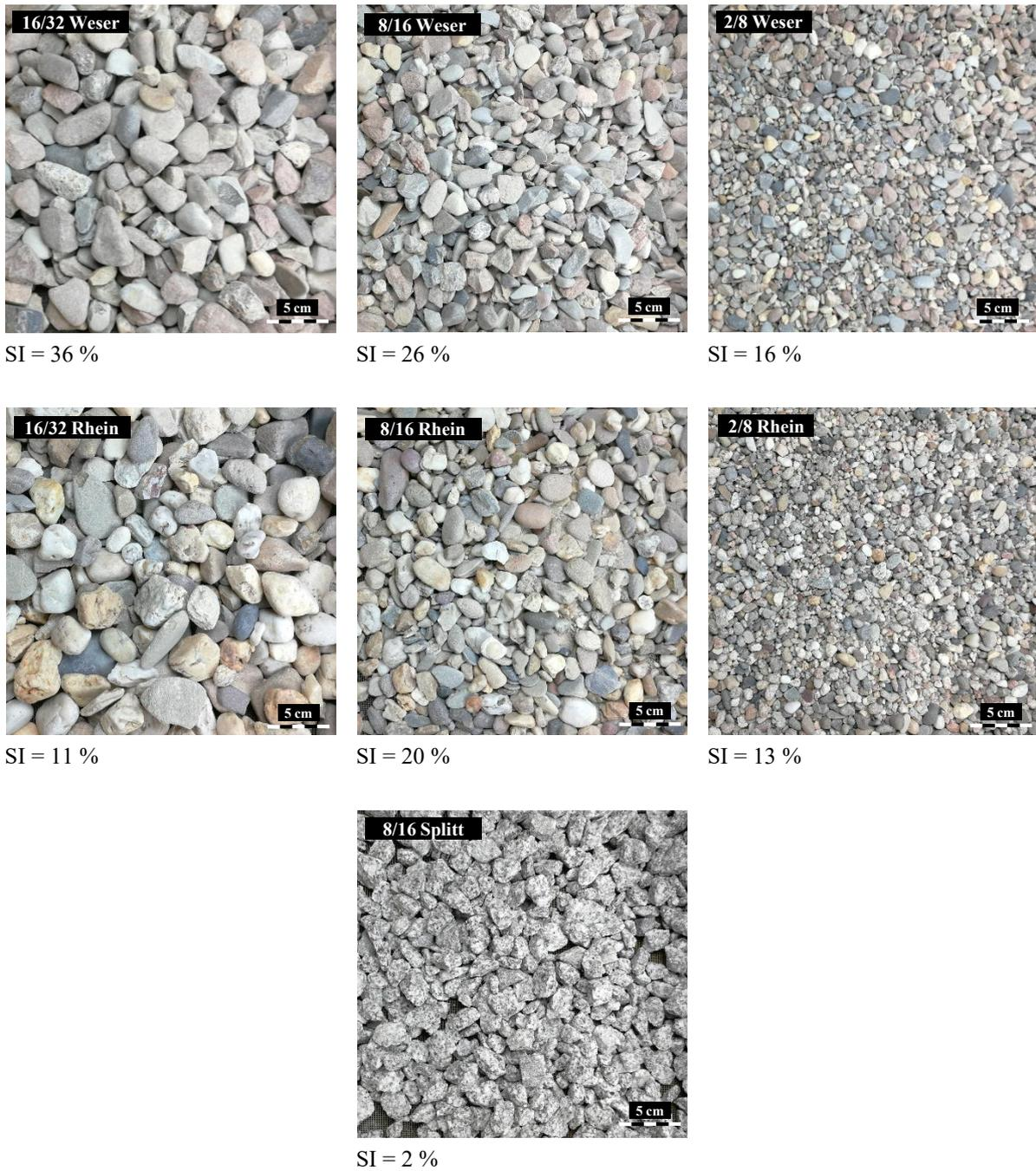
**Abbildung B1.3:** Visueller Eindruck der verwendeten Gesteinsarten der einzelnen Fraktionen (2/8, 8/16, 16/32) mit dazugehörigen Kornformparametern; SI = Shape-Index gemäß *DIN EN 933-4:2015-01*
