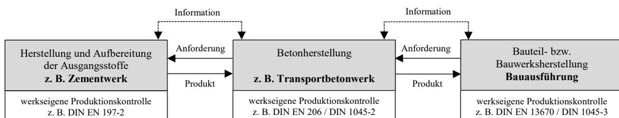
**Abbildung 2.1:** Qualitätskette und Informationsfluss zwischen den einzelnen Parteien bei der Herstellung und Verarbeitung von Beton (in Anlehnung an (VDZ2008))
