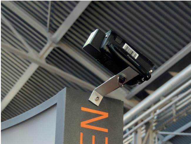
Abbildung 4.2: In der ersten Studie im Industriemuseum wurde die Kamera mit einem Aluminium-Profil an einer Stele in zwei Meter Höhe angebracht. Die Interaktion am Tisch konnte so von oben erfasst werden. (Foto: K. Kanellopoulos 2013)
