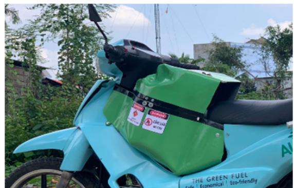
Hình 9: Hình ảnh xe Wave S 110 với hệ thống phun nhiên liệu LPG
