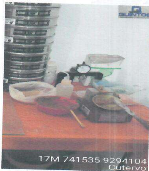
Fig.15: Proceso del ensayo de Limite Liquido.
