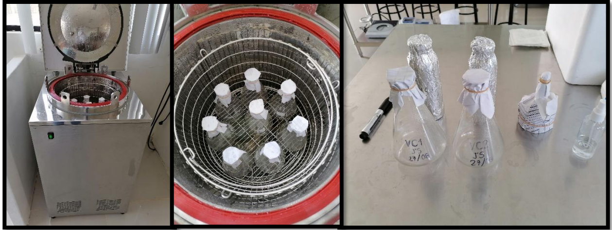
Figura 23. Esterilización de materiales en autoclave (115°C x 1h)
