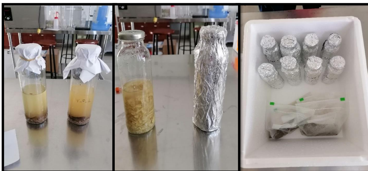
Figura 22. Maceración (T° ambiente, oscuridad y agitación periódica) de extractos con etanol 96°
