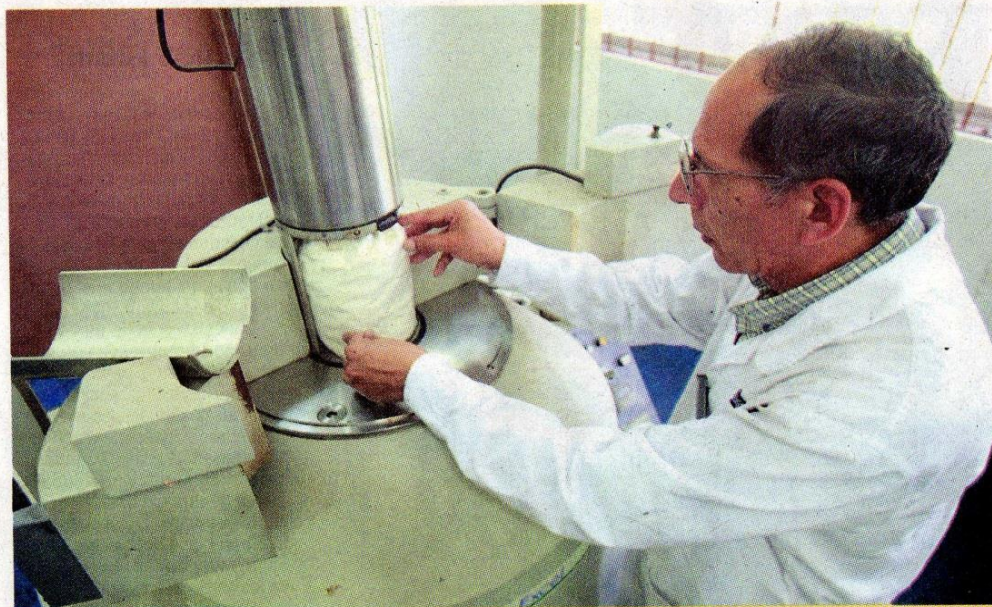
Laboratorio. Vargas durante una prueba de irradiación de harina de maca en el equipo Gammacell 220, en el IPEN.
