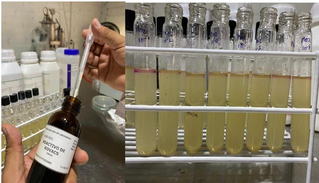
*Nota:* la figura demuestra la aplicación de la prueba de Indol, a los tres últimos positivos al crecimiento de bacterias termotolerantes (45 °C), para la identificación de coliformes fecales.
