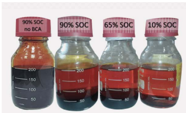
Figura 70. Formación de complejo Br 2 -BCA en diferentes estados de carga 175 .
