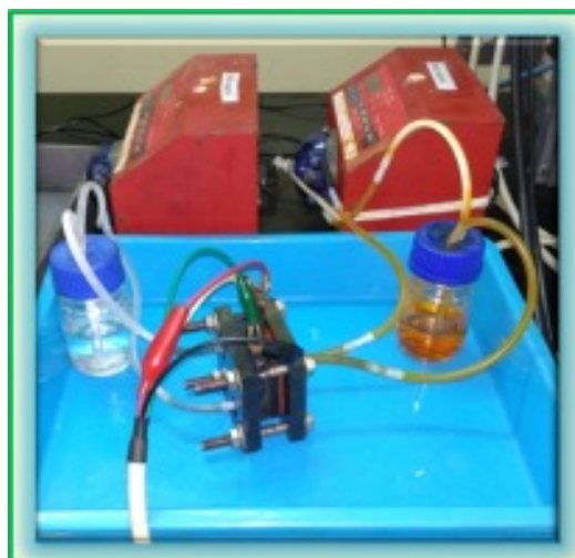
Figura 84. Aspecto de los electrolitos durante la carga de la ZBFB: naranja catolito e incoloro anolito 192 .
