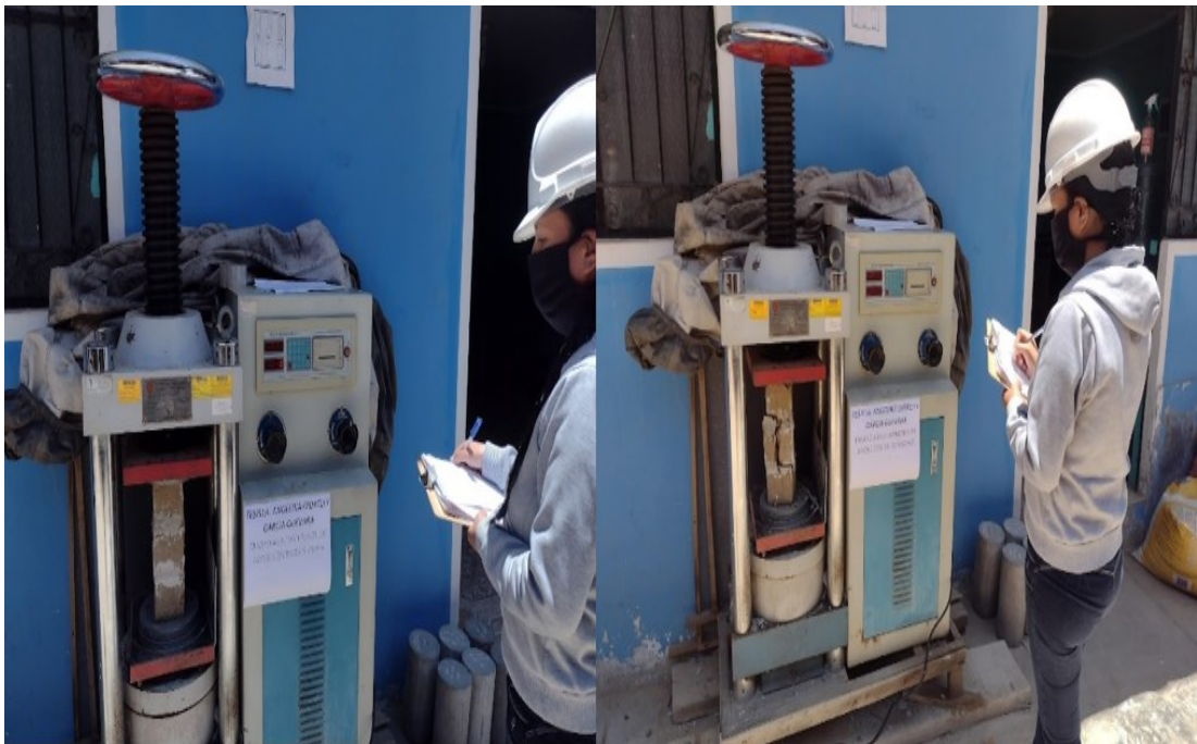
En la imagen se aprecia las roturas del conjunto de bloques de adobes, en las cuales se tomaron las medidas de la propiedad mecánica específicamente de la resistencia a la compresión los cuales soportaron aquellos bloques.
