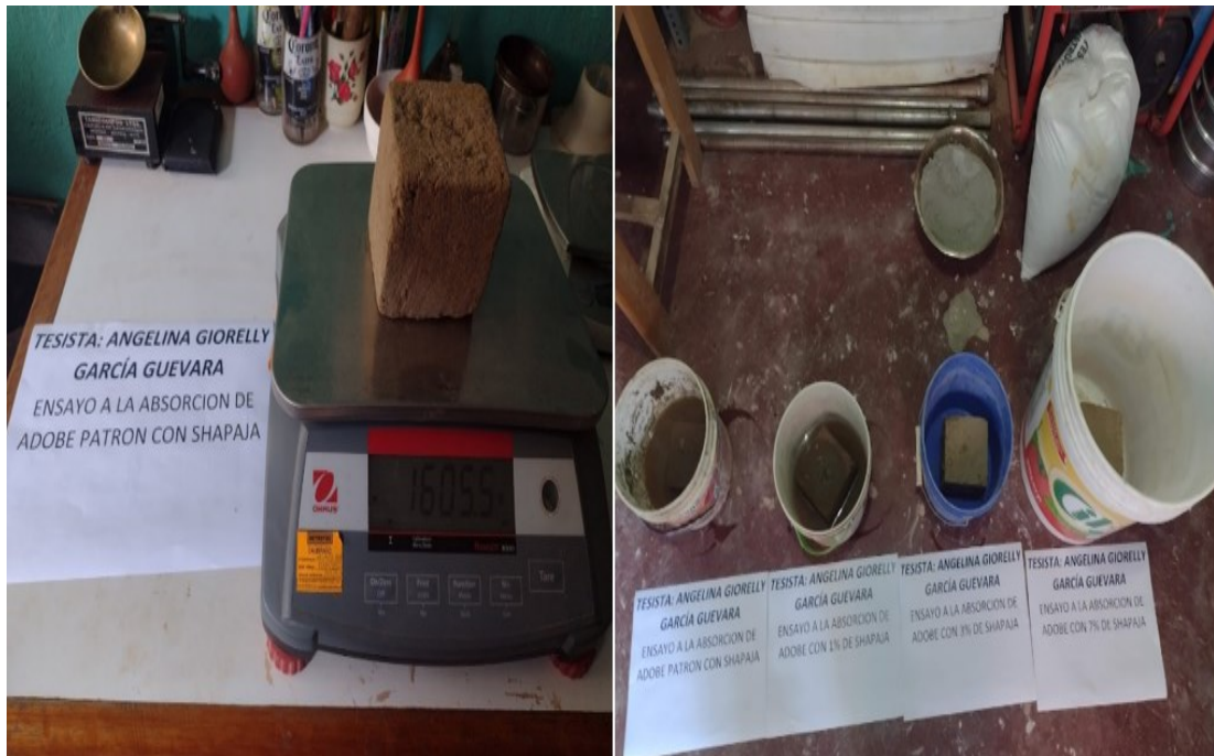
En la fotografía se muestra la selección de las mejores muestras de los bloques de adobe y su posterior pesaje.
