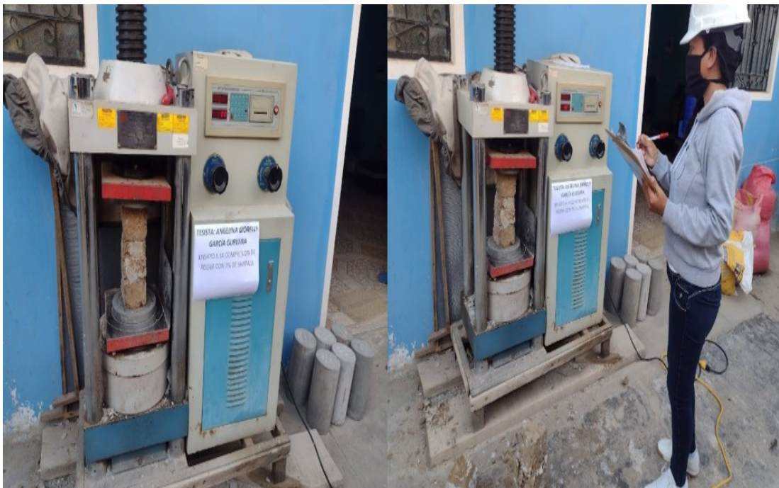
En la imagen se puede apreciar el relleno de las fichas de análisis de la propiedad mecánica específicamente de la resistencia a la compresión del conjunto de bloques de adobes patrón como también del conjunto de bloques de adobes que tienen porcentajes de shapaja añadido.
