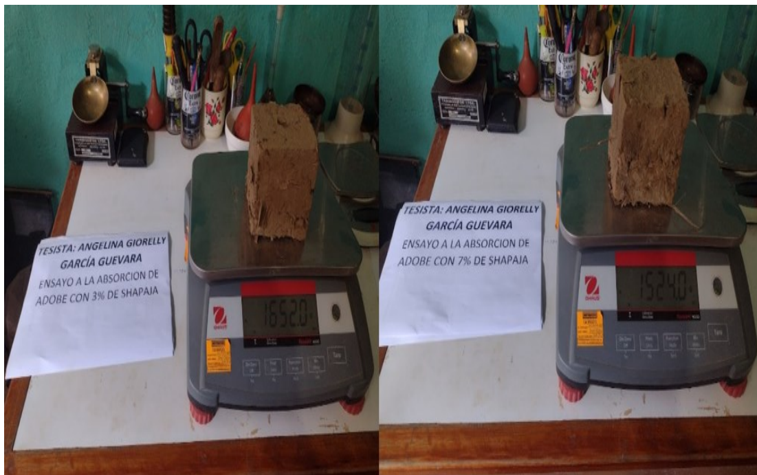
En la imagen se muestra el pesaje de los mejores del conjunto de bloques de adobes con porcentajes de fibras de shapaja
