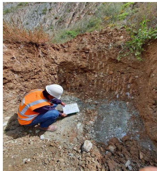
Vista del estrato superior (Material generado por sedimentación y deslizamiento del material superior del talud).
