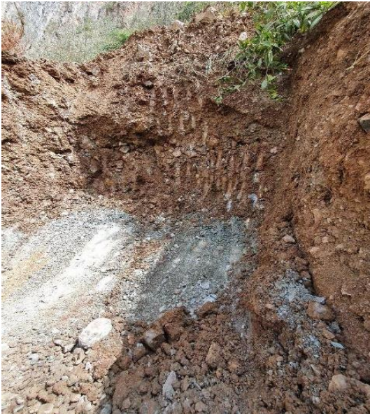
Vista del estrato superior (Material generado por sedimentación y deslizamiento del material superior del talud).
