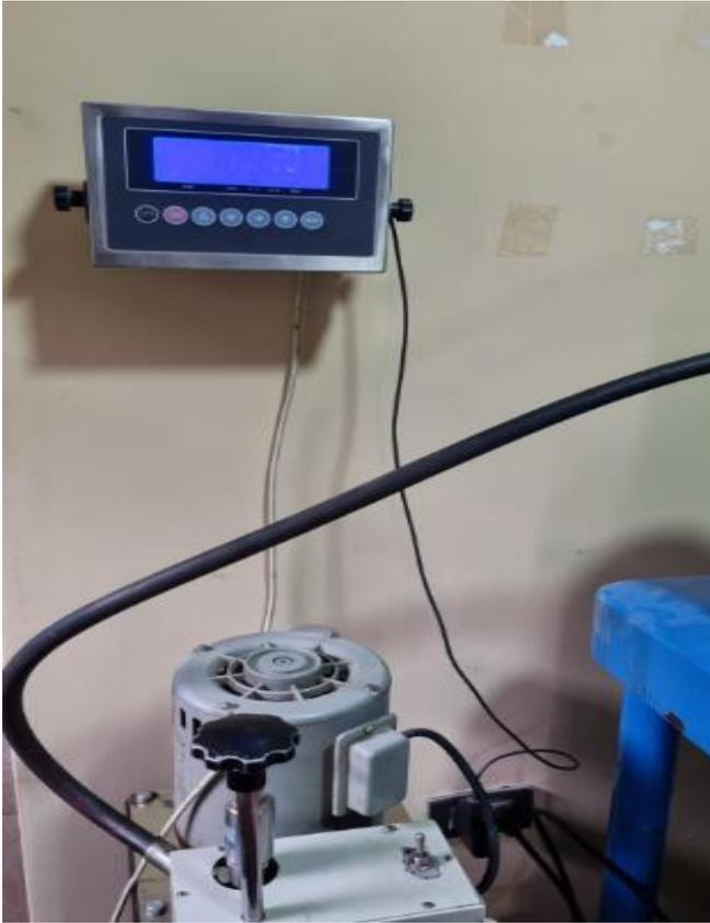
*Fotografía 5. Cargas obtenidas en el ensayo a compresión de especímenes.*
