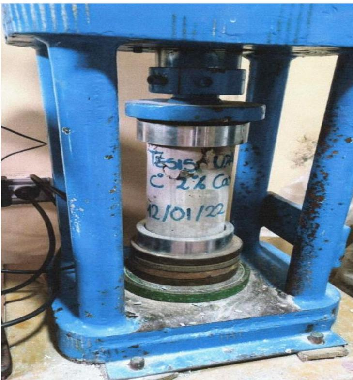
Fotografía 2. Rotura de probeta de concreto  $f'c = 210 \text{ kg/cm}^2$  con adición del 6%
