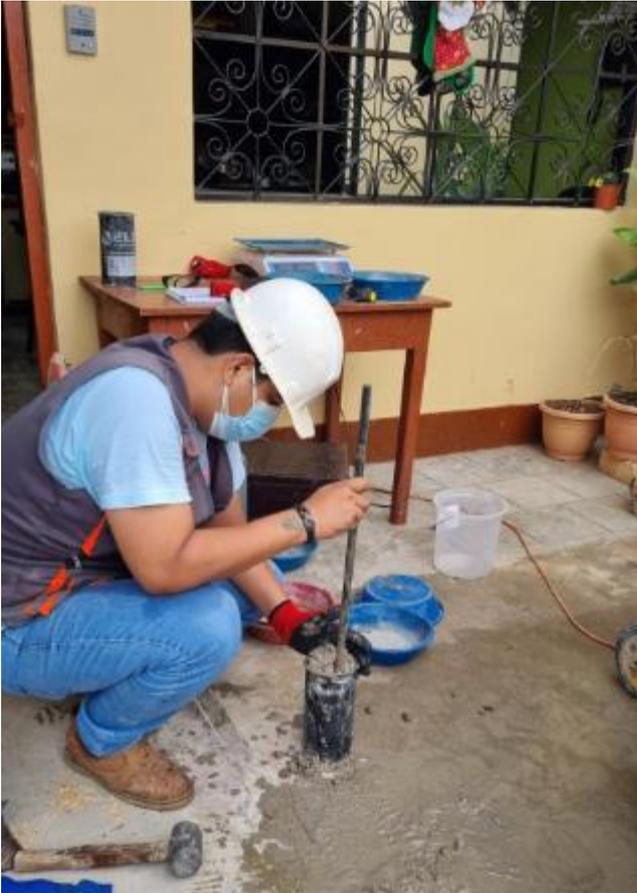
Fotografía 11. Elaboración de probetas de concreto.
