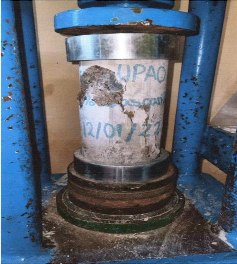
Fotografía 3. Rotura de probeta de concreto  $f'_c = 210 \text{ kg/cm}^2$  con adición del 4%
