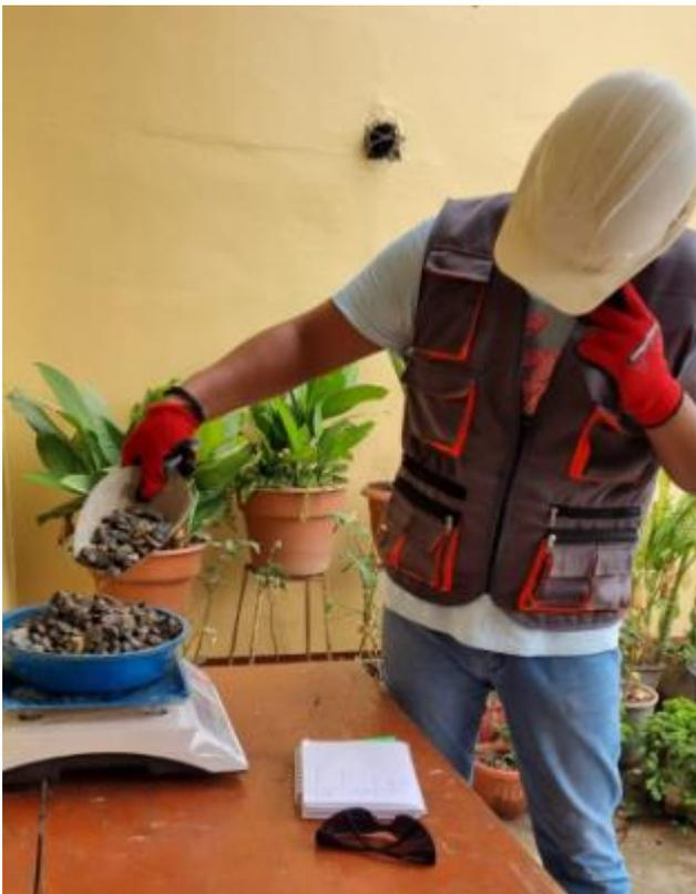
*Fotografía 8.* Ensayo de granulometría de los agregados.
