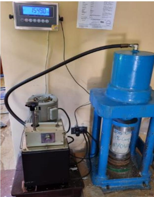
Fotografía 12. Ensayo a compresión de probetas de concreto.
