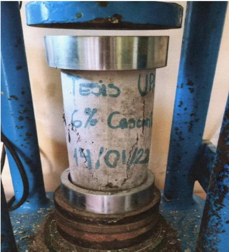
Fotografía 4. Rotura de probeta de concreto  $f'_c = 210 \text{ kg/cm}^2$  con adición del 6%.
