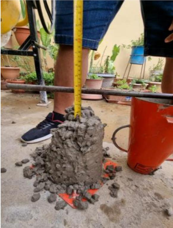
*Fotografía 7.* Ensayo de asentamiento del concreto fresco.
