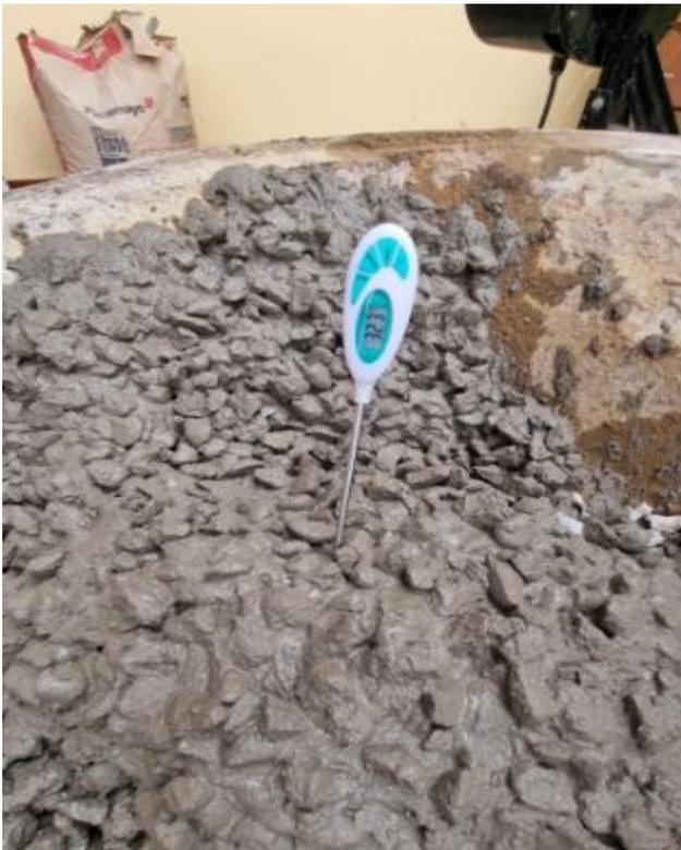
*Fotografía 6. Temperatura del concreto en su estado fresco.*
