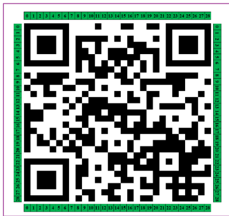
FIGURA 2. SÍMBOLO DE UN CÓDIGO QR VERSIÓN 3, 29 FILAS Y 29 COLUMNAS DE LA 0 A LA 28
