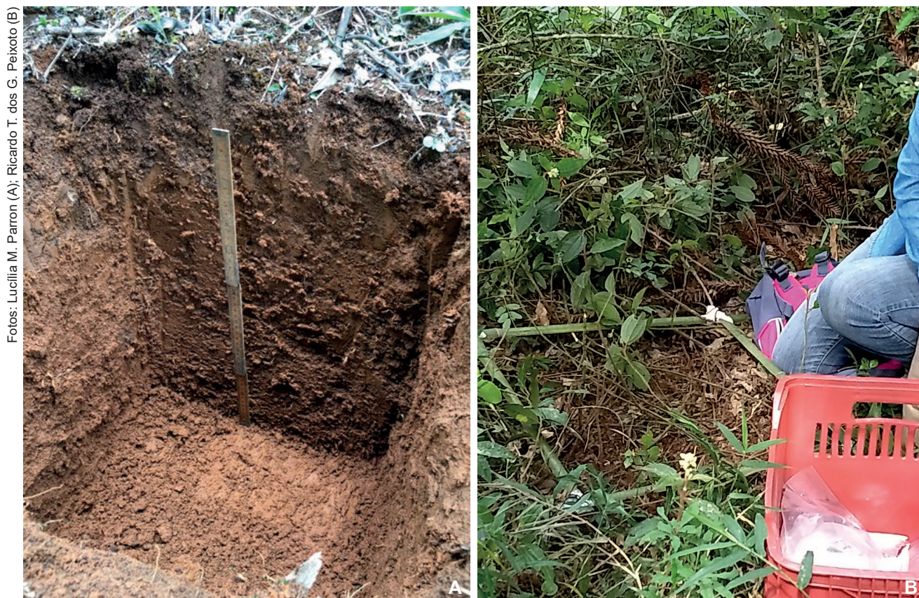
Figura 6. Trincheira para amostragem de solo (A) nas camadas de 0-10 cm, 10-20 cm e 20-40 cm de profundidade, e amostragem de serapilheira (B).
