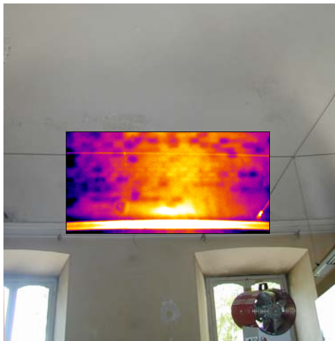
Fig. 10 - Transitorio termico di raffreddamento della volta della biblioteca (sulla destra). La termografia evidenzia la tessitura muraria della volta (sulla sinistra).
