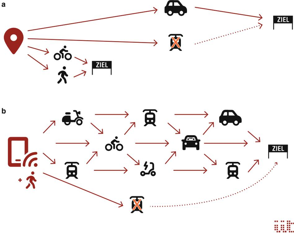
Abb. 9.1 Gesteigerte Redundanz in einem digitalen und multimodalen Mobilitätssystem. **a** Altes, nicht digitales und nicht vernetztes Mobilitätssystem, begrenzte Reichweite im monomodalen Rad-/Fußverkehr. **b** Vernetztes multimodales System, mit erhöhter Redundanz, die im Störfall (unterster Pfad) Alternativen bietet. Dazu neue Mobilitätsformen/angebote, wie Carsharing und Darstellung eines Nutzenden mit App. (Quelle: Institut für Innovation und Technik (iit), eigene Darstellung)
