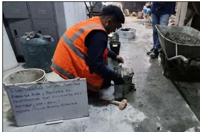
Figura 50. Ensayo de masa unitaria
