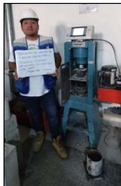
Figura 63. Ensayo de resistencia a tracción a los 14 días
