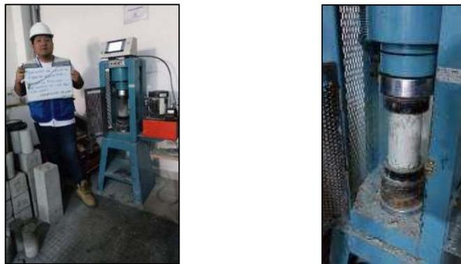
Figura 56. Ensayo de resistencia a compresión a los 14 días
