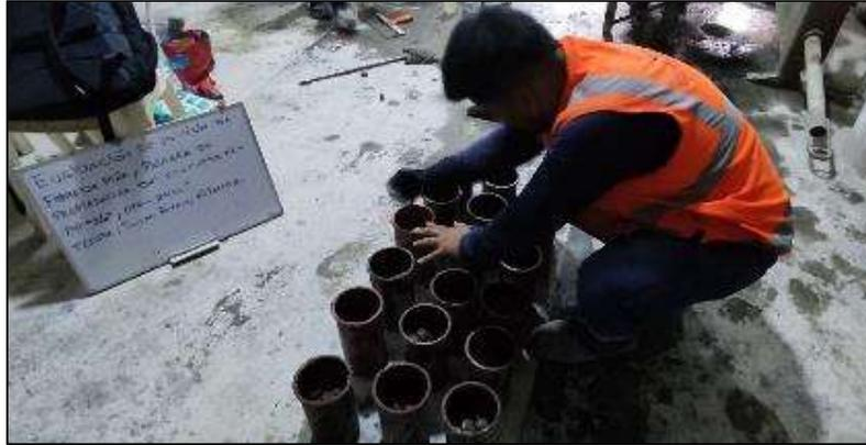
Figura 39. Elaboración de especímenes cilíndricos
