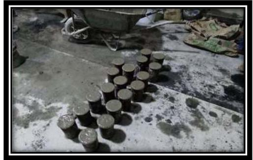
Llenado de moldes cilíndricos
