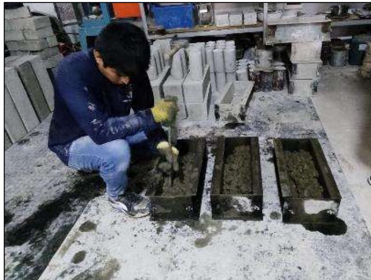
Figura 40. Elaboración de vigas de concreto
