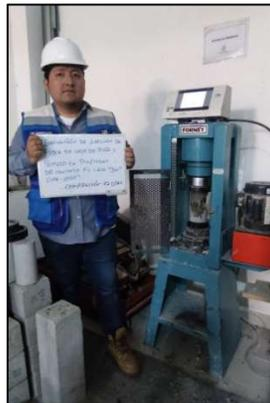
Figura 54. Ensayo de resistencia a compresión a los 7 días
