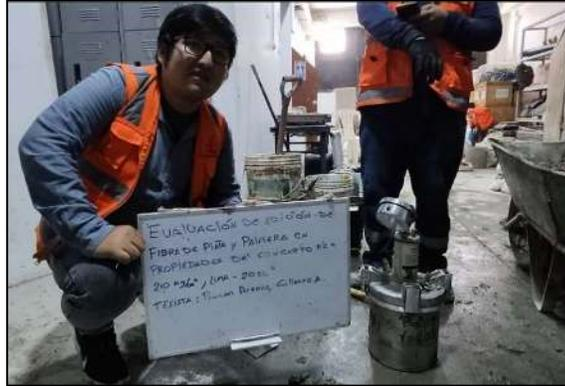
Figura 52. Ensayo de contenido de aire
