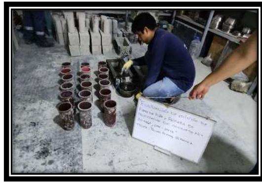
Aplicación de aditivo desmoldante en molde cilíndrico y prismático
