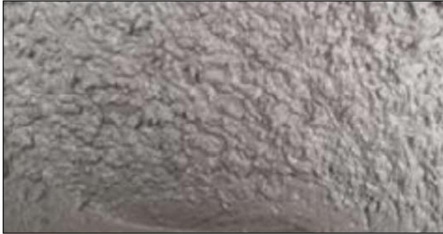
Figura 10. Textura de concreto en estado fresco
