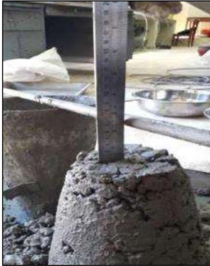
*Figura 13. Medición del Slump*
