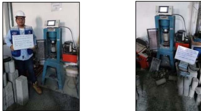
Figura 58. Ensayo de resistencia a compresión a los 28 días
