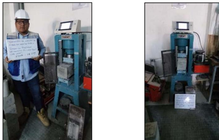
Figura 68. Ensayo de resistencia a flexión a los 28 días
