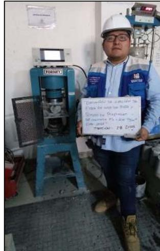
Figura 65. Ensayo de resistencia a tracción a los 28 días
