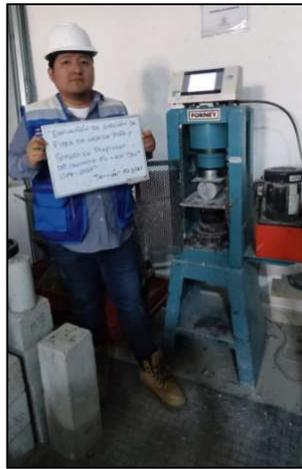
Figura 61. Ensayo de resistencia a tracción a los 7 días
