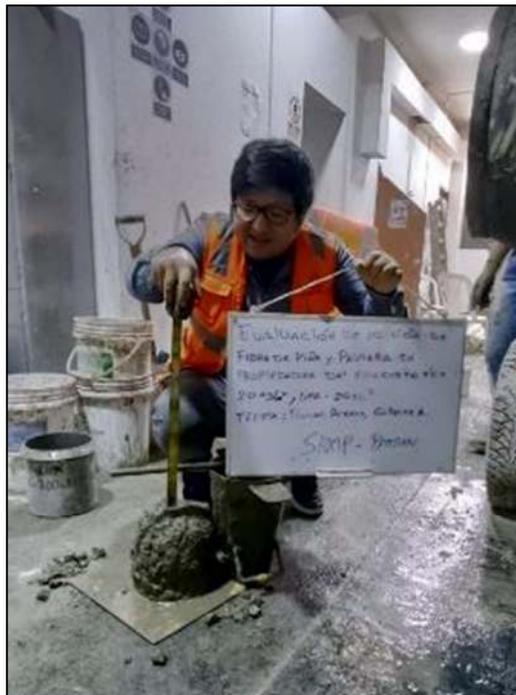
Figura 48. Medición de Asentamiento
