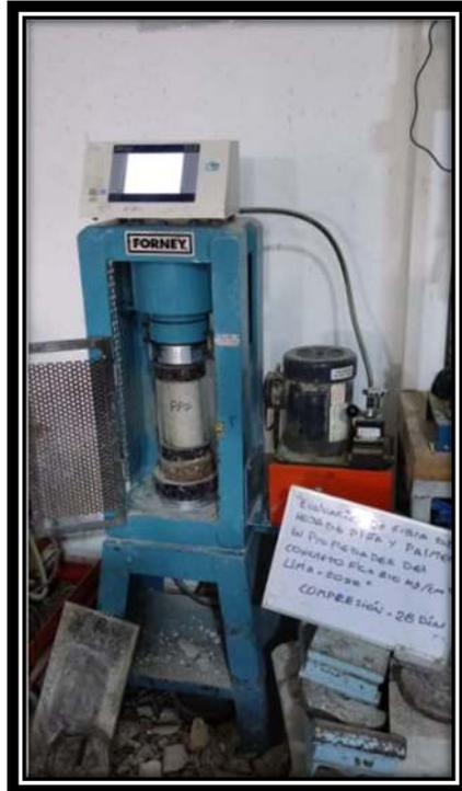
Ensayo de Resistencia a la tracción
