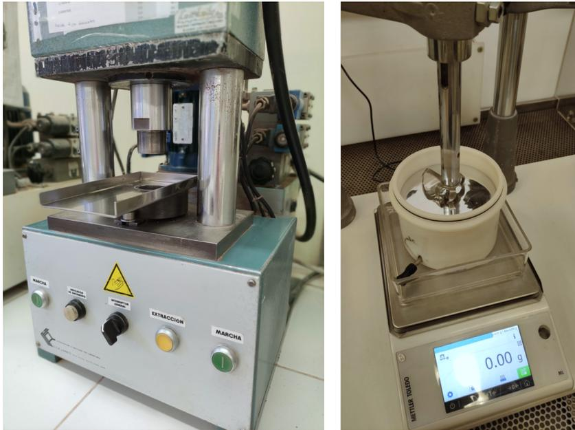
**Figura 3.2.** Equipamiento de laboratorio empleado en la determinación del comportamiento de los materiales durante el conformado: prensa hidráulica (izquierda) y sistema de medida de densidad aparente (derecha).
