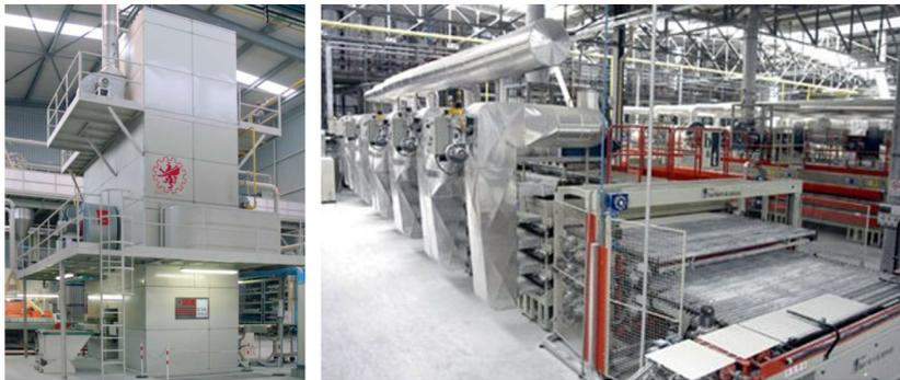
**Figura 1.4.** Secadero vertical (izquierda, cortesía de SACMI Coop.) y horizontal (derecha, cortesía de Siti-B&T) empleados en el secado de los soportes de baldosas cerámicas.
