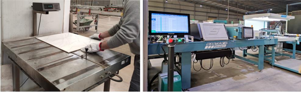
**Figura 3.8.** Mesa de caracterización dimensional y clasificadora industrial empleadas en la medida del tamaño de soportes y piezas terminadas durante la investigación.
