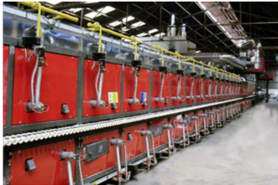
**Figura 1.6.** Horno monoestrato de rodillos a gas natural empleado en la cocción de baldosas cerámicas (cortesía de Siti-B&T).
