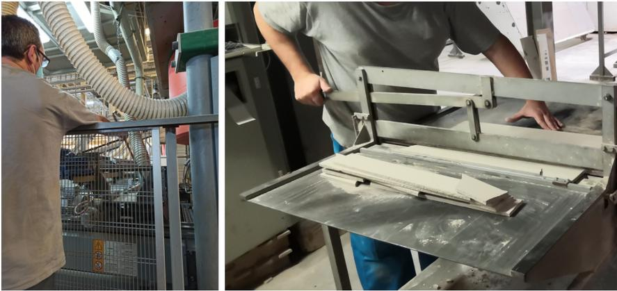
**Figura 3.9.** Muestreo de polvo atomizado en el sistema de alimentación de la prensa y preparación de muestras para la medida de la densidad aparente de los soportes.
