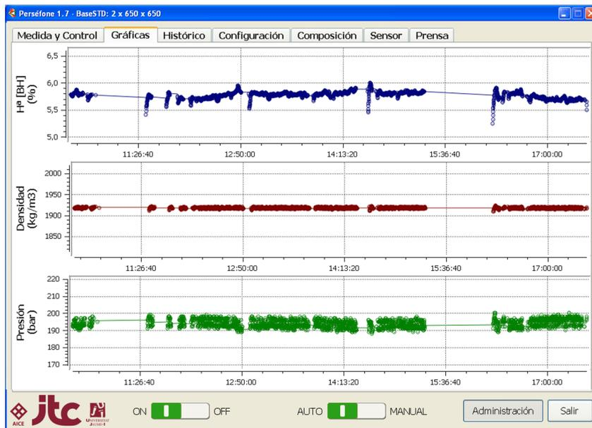
**Figura 4.51.** Pestaña de visualización gráfica del interfaz de usuario de la aplicación desarrollada para el control de la operación de prensado.
