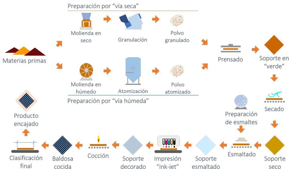
**Figura 1.1.** Esquema del proceso de fabricación de baldosas cerámicas prensadas.
