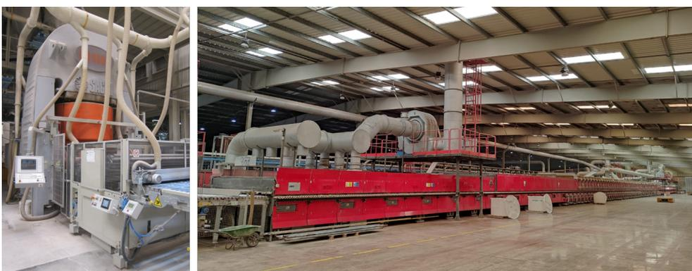
**Figura 3.7.** Prensa hidráulica (izquierda) y horno monoestrato de rodillos (derecha) empleados en la experimentación industrial de la investigación.
