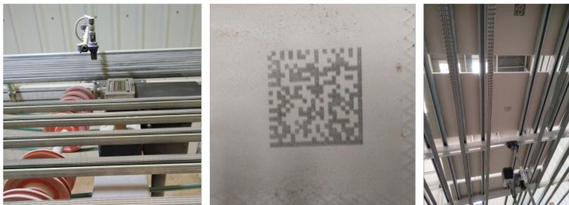
**Figura 6.1.** Sistema de trazabilidad en fase de desarrollo. De izquierda a derecha, cabezal de impresión, código DM y cámara registrando el paso de soportes codificados.
