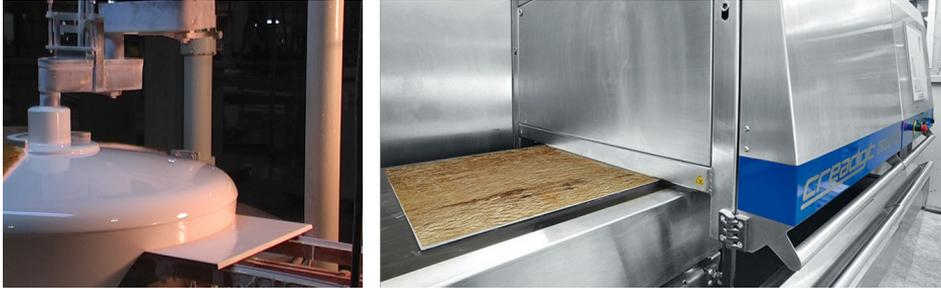
**Figura 1.5.** Aplicación de esmalte a cortina (izquierda) y decoración mediante impresión por chorro de tinta (derecha, cortesía de System Ceramics).
