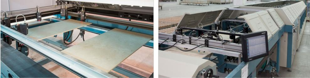
**Figura 1.7.** Sistema telemétrico para medida dimensional (izquierda) y línea de clasificación de baldosas cerámicas (derecha)(cortesía de System Ceramics).
