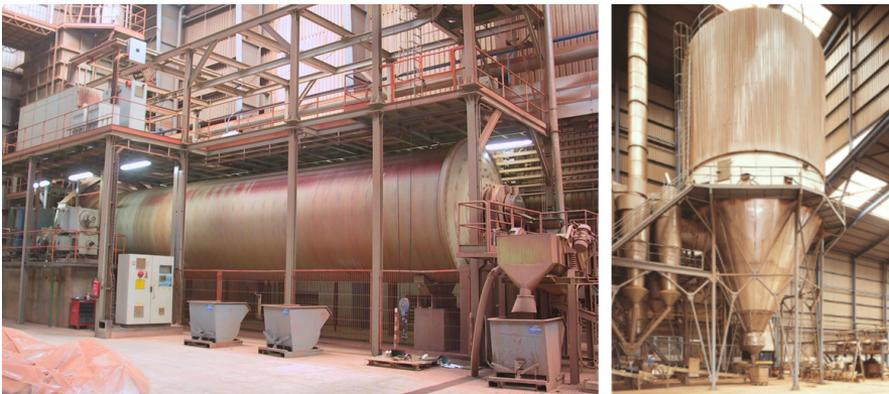
**Figura 1.2.** Molino continuo de bolas (izquierda) y atomizador (derecha) empleados en la preparación de la composición del soporte por “vía húmeda”.
