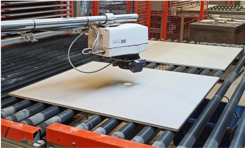
**Figura 3.11.** Transductor de humedad por espectrometría NIR modelo CM710e de la firma NDC Infrared Engineering instalado a la salida de la prensa.
