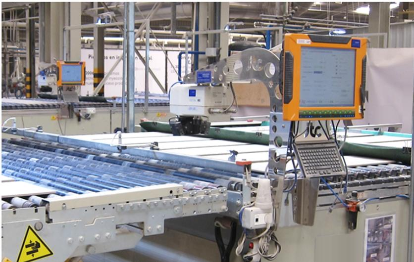
**Figura 4.48.** Equipo de medida de la humedad y PC industrial en el que se ejecutaba la aplicación de control automático desarrollada.
