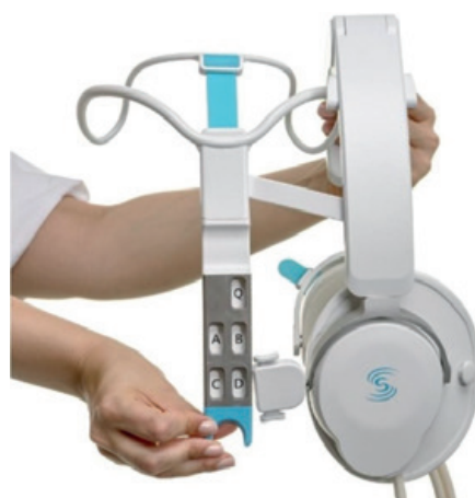
Рис. 2. Узел датчиков и инструмент для регулировки их положения.
