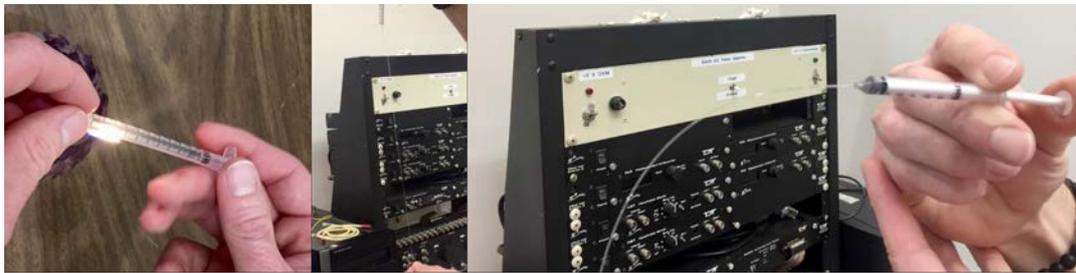
Figura 3.3: *Pulled plastic syringe*. Proceso de producción de esta jeringa, con el fin de obtener un diámetro mínimo para la aplicación precisa del cianoacrilato en las áreas de interés.
