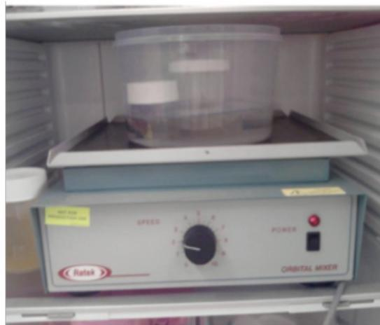
Figura 3.13: Curado o endurecimiento. El bloque de hueso con resina, colocado en contenedor de agua en el frigorífico.
