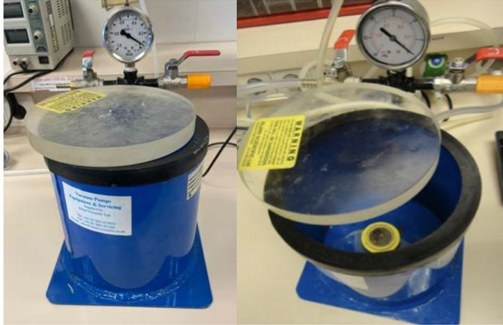
Figura 3.12: Cámara de vacío. Hueso temporal embebido en resina dentro de cámara de vacío.
