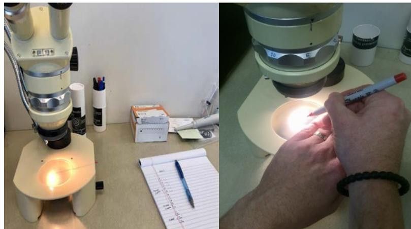
Figura 3.8: Medición de las muestras bajo control microscópico. Cálculo del volumen exacto de cada una de las muestras obtenidas para cada espécimen.
