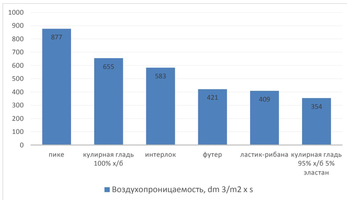
Рисунок 7 - Результаты испытаний материалов на воздухопроницаемость
