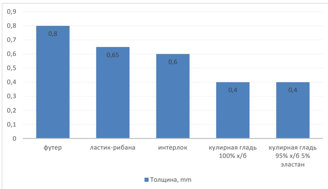
Рисунок 2 - Результаты испытаний материалов на толщину
