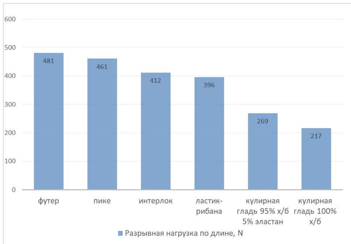
Рисунок 3 - Результаты испытаний материалов на разрывную нагрузку
