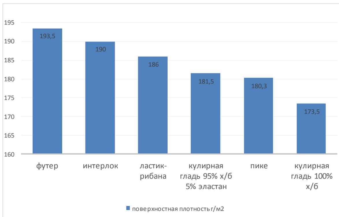
Рисунок 1- Результаты испытаний материалов на поверхностную плотность
