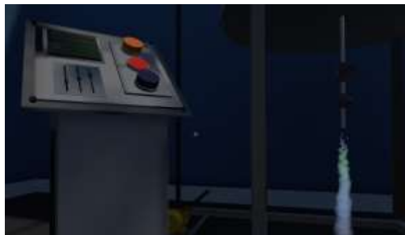
Figura 9. A la izquierda se observa el panel con el botón central presionado para activar la descarga, apreciable a la derecha.
