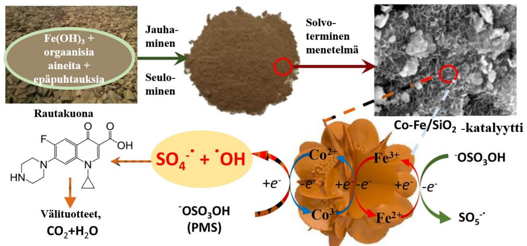
Kuva 4. Vedenpuhdistuksessa syntyneen rautalietteen muokkaamisprosessi katalyytiksi sekä sen toiminta peroksidimonosulfaattihapetusreaktiossa siprofloksasiinin hajottamiseksi. 17
