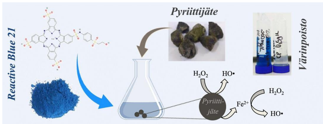
Kuva 6. Pyriittijätekatalyytin toiminta Reactive Blue 21 -väriaineen poistossa Fenton-reaktiolla. 28
