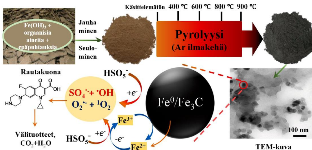
Kuva 5. Rautalietteen muokkaamisprosessi \text{Fe}_0/\text{Fe}_3\text{C} -katalyytiksi ja sen toiminta peroksidimonosulfaattihapetusreaktiossa siprofloksasiinin hajottamiseksi. 25
