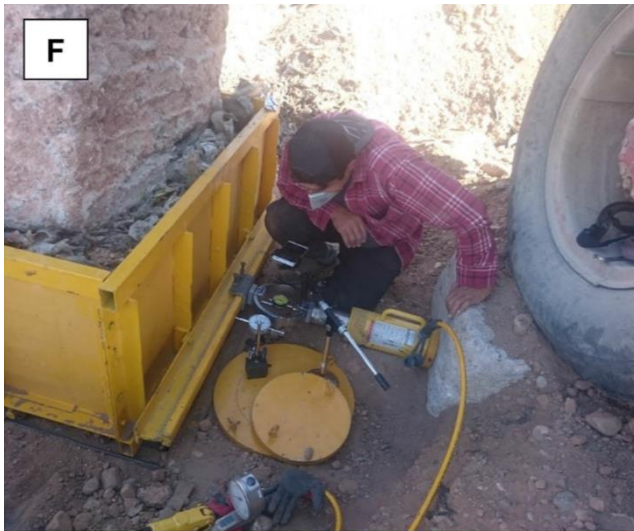
Kuva 23. Jätteen niin sanottu large-scale in-situ rasialeikkauskoe yksinkertaisimmillaan (Keramati, et al., 2020).
