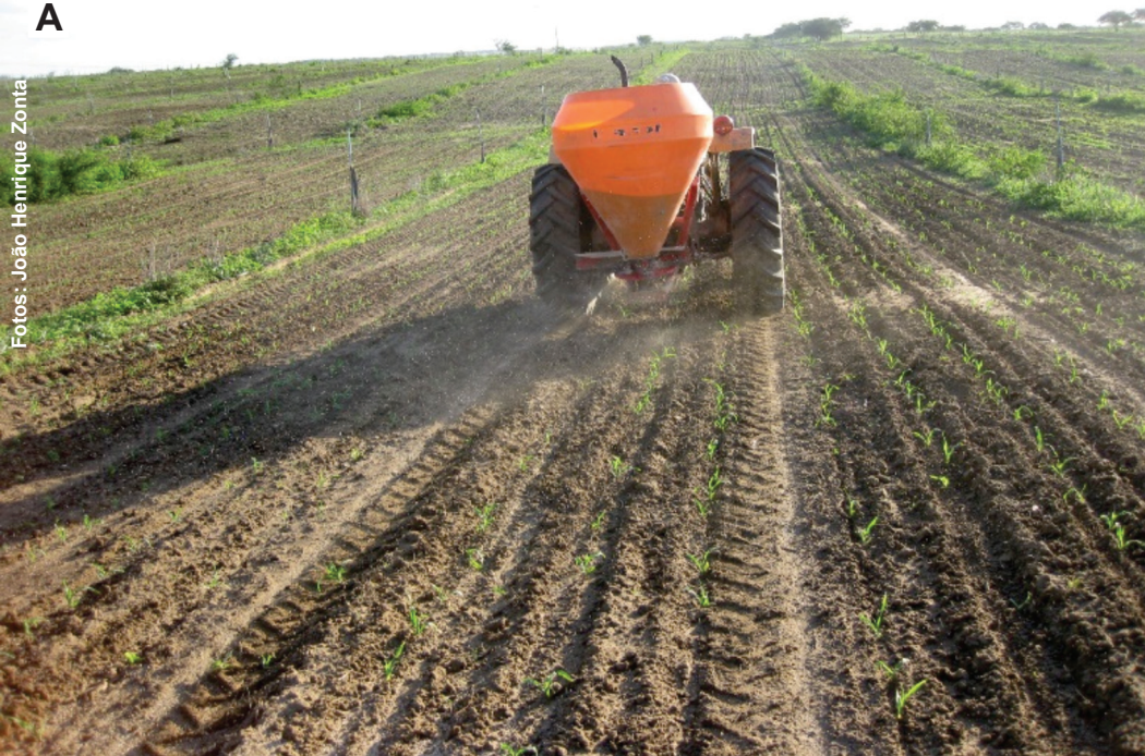
Figura 7. Plantio de capim através de aplicação a lanço misturado ao adubo nitrogenado após a emergência do milho (A) e semeadora a lanço instalada na frente do trator (B).
