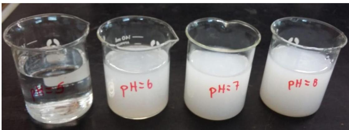
**Figura 5:** Amostras sintéticas precipitadas com diferentes pHs após adição de solução de fosfato e solução de cloreto de cálcio.
