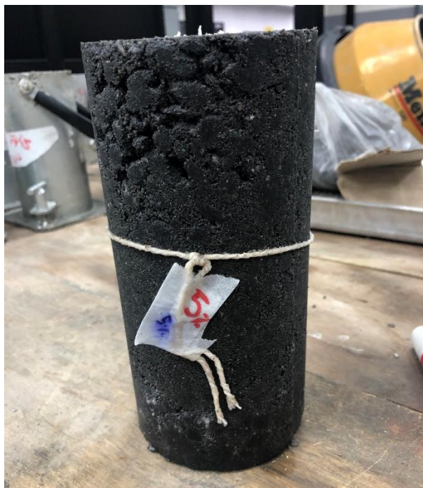
Figura 22: Corpo de prova desmoldado e identificado.
