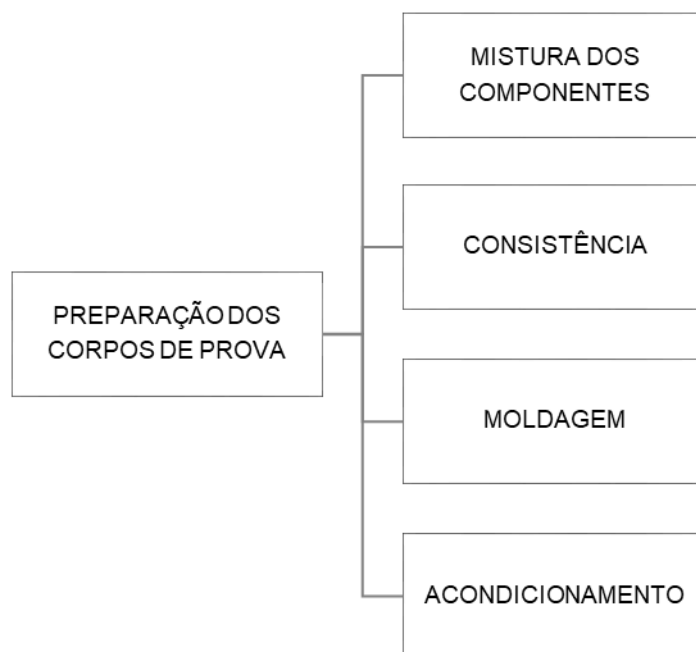
Figura 14: Fluxograma das etapas da preparação do corpos de prova.
