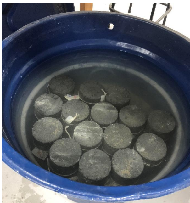
Figura 21: Corpos de prova imersos em água não corrente com cal.
