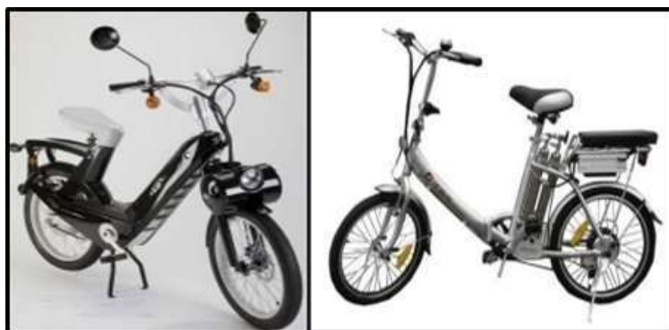
Figura 2: Bicicletas elétricas (com bateria e célula combustível, respectivamente).
