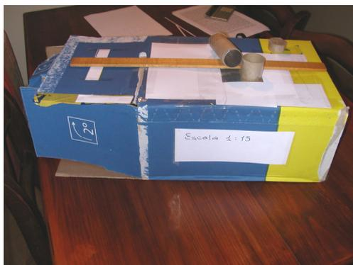
Dois tubos (número 3 e número 4), foram testados utilizando o modelo. Os dois tubos usados foram feitos de latas de alumínio, reproduzindo em escala tubos de dimensões reais de:
