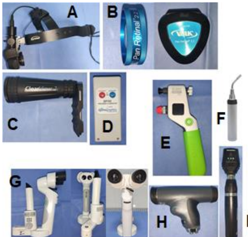
Figura 7: Equipamentos oftálmicos utilizados durante as consultas. (A) Oftalmoscópio indireto, (B) Lente, (C) ClearView 2 para mapeamento de retina, (D) CPLR, (E) Tonômetro, (F) Transiluminador de Finoff, (G) Biomicroscópio com lâmpada de fenda, (H) Oftalmoscópio com panóptico, (I) Oftalmoscópio direto.
