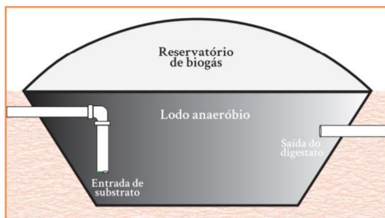
Figura 2 - Biodigestor de Lagoa Coberta.
