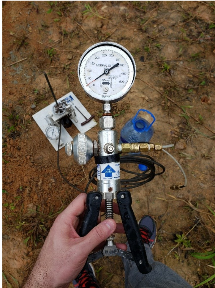
Figura 29 – Bomba manual usada para aplicação da tensão de consolidação
