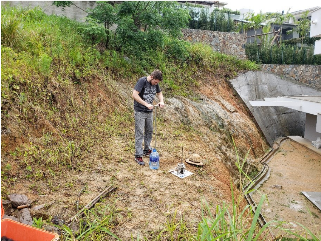
Figura 26 – Execução de tradagem no local de estudos
