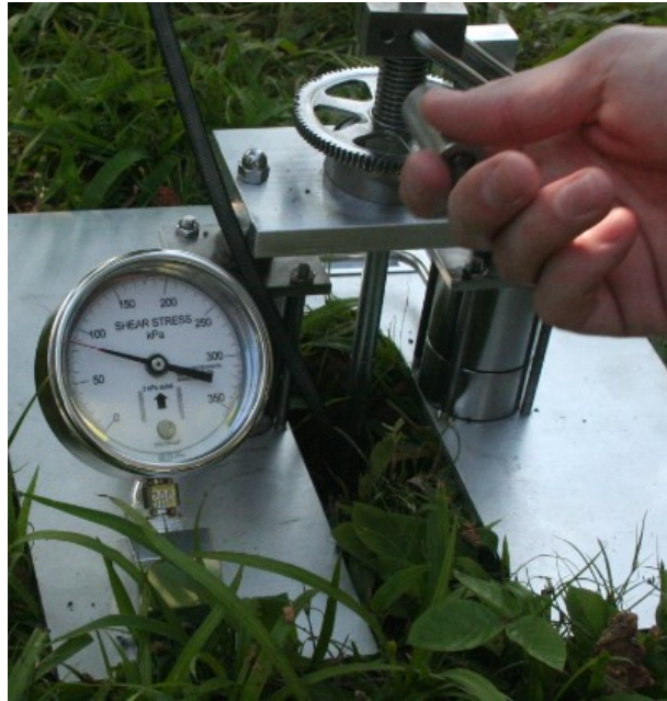
Figura 19 – Registro do aumento da tensão cisalhante ao rotacionar a manivela
