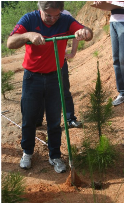
Figura 16 – Utilização do trado para a execução do furo de sondagem
