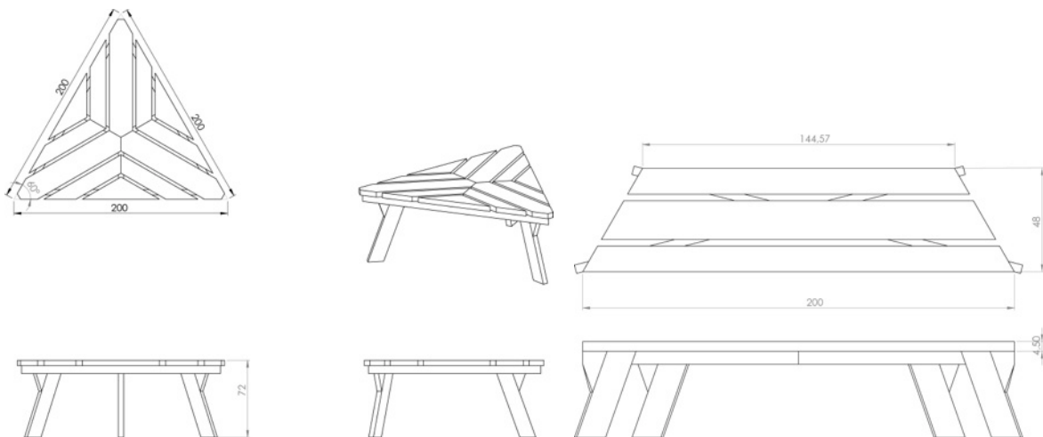
Figura 5: Desenhos técnicos com as dimensões gerais da mesa e do banco. Fonte: Autores.
