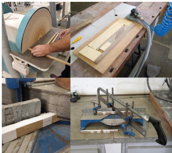
Figura 8: Refinamento com lixadeira circular e manual; nivelamento com lixadeira roto orbital pneumática; corte angulado dos encaixes com a serra de arco. Fonte: Autores.
