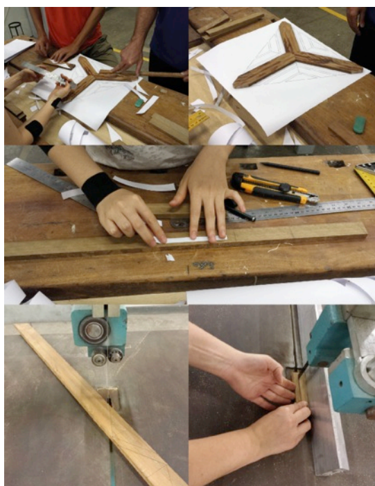
Figura 7: Seleção das ripas; transposição do desenho técnico nas ripas; corte em serra de fita. Fonte: Autores.
