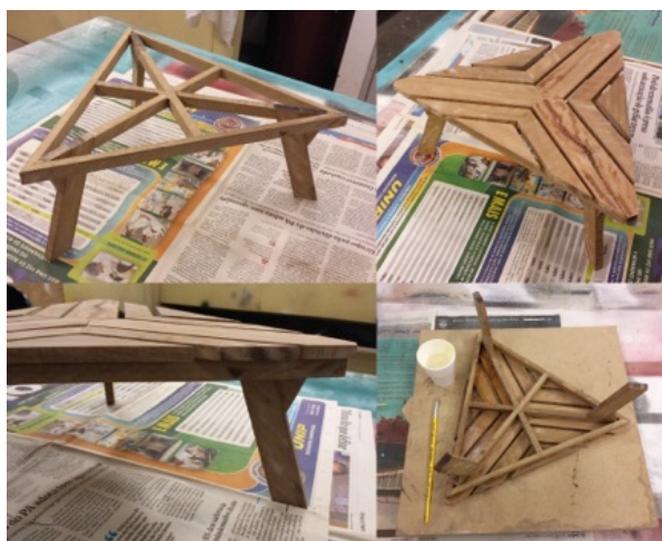
Figura 11: Finalização do processo de colagem da mesa (tampo); para o acabamento, houve a aplicação de verniz marítimo acetinado a base d'água. Fonte: Autores.
