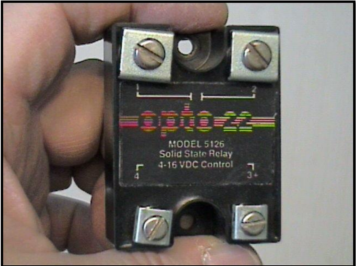
Figura 39- Relé de Estado Sólido Opto 22 Modelo 5126.
