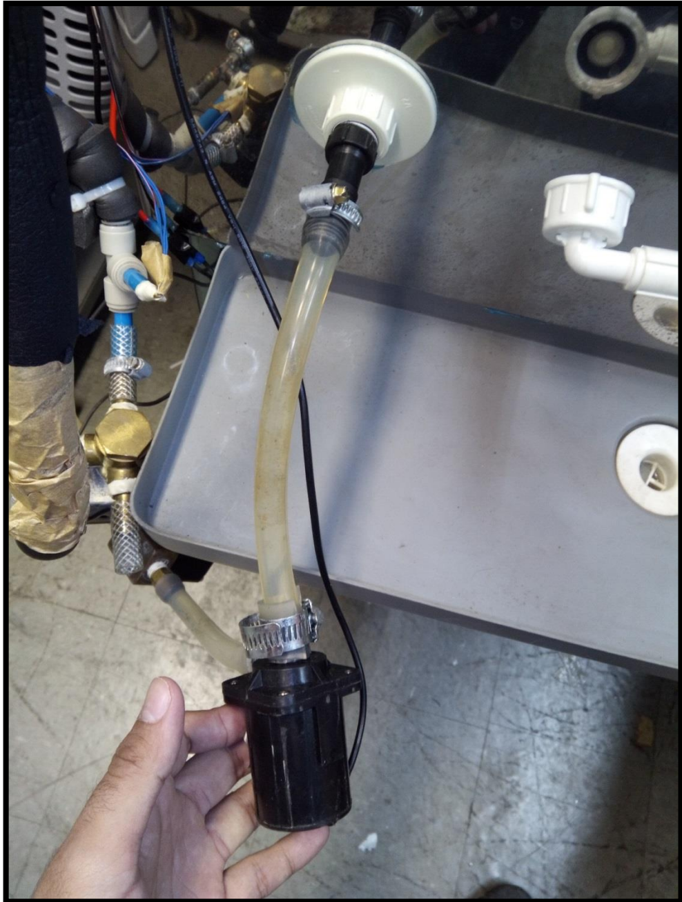
Figura 64-Foto da bomba hidráulica (Hydraulic Pump).
