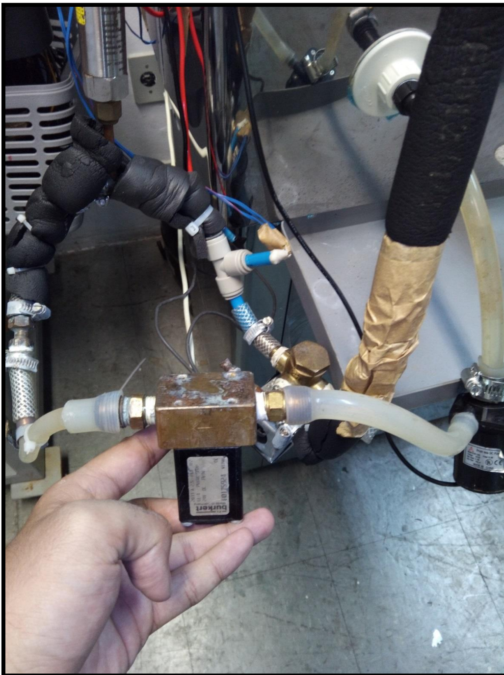
Figura 65-Foto da válvula proporcional (Prop. V.) .
