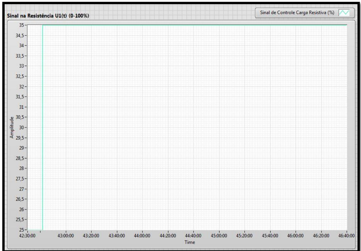
Figura 14 - Medição de u_1(t) no ensaio em malha aberta realizado para identificar seu modelo G_1(s) . O gráfico acima foi diretamente retirado do software em LabVIEW usado para realizar esta medição.
