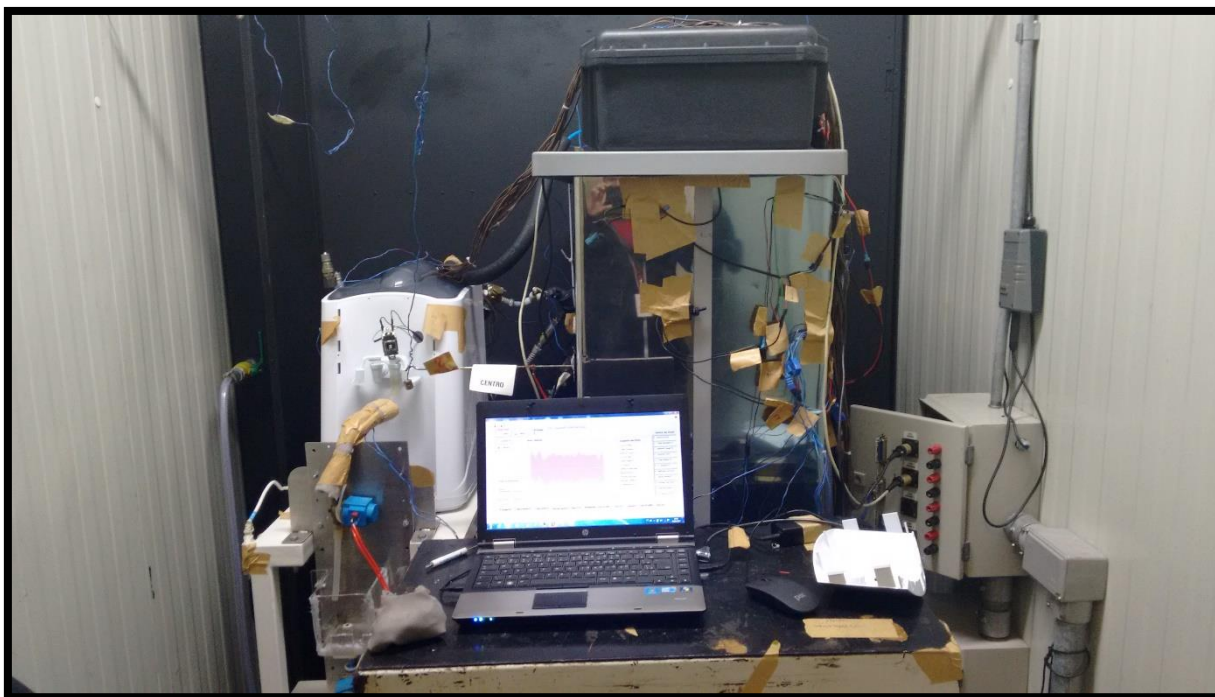
Figura 60-Foto da bancada realizando ensaios com um bebedouro.
