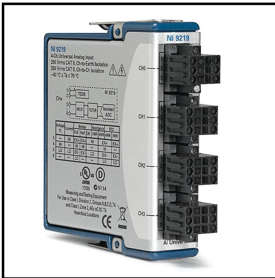
Figura 32-Módulo de entrada analógica universal tipo NI 9219, com integração às tecnologias CompactDAQ ou CompactRIO.
