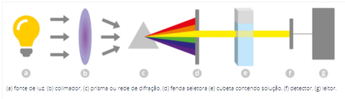
Figura 11 - Componentes do espectrofotômetro
