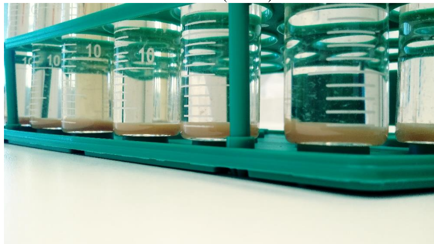
Figura 6- Soluções obtidas para reação de Lugol: recipiente contendo apenas mel (esquerda), recipiente contendo mel e Lugol (centro), recipiente contendo mel, Lugol e amido adicionado intencionalmente (direita).
