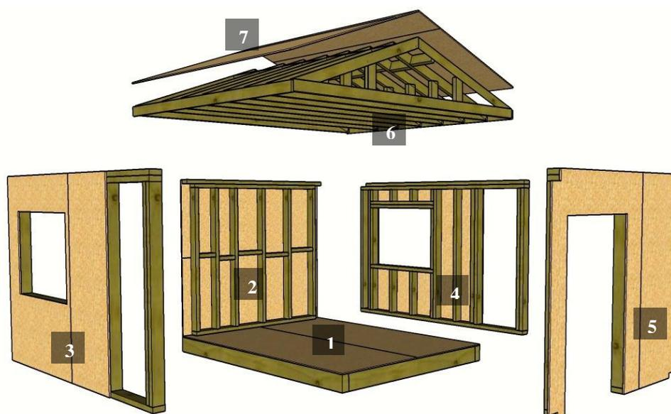
Figura 9: Sequência para execução da casinha no canteiro. Fonte: Elaborado pelos autores.
