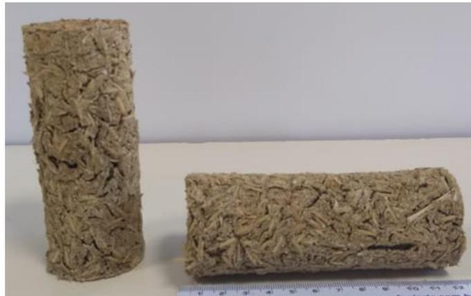
Figura 1: Biocombustível sólido confeccionado. Fonte: Elaborado pelos autores.
