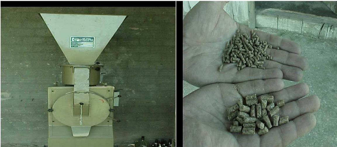
Figuras 8 e 9: Peletizadora para produção de ração e pelets produzidos. Fonte: Autor, 2012
