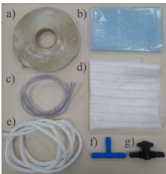
Figura 19 - Materiais consumíveis: a) Fita selante, b) Bolsa de vácuo, c) Mangueira cristal, d) Peel ply , e) Espiroduto, f) Tê e g) Registro.
