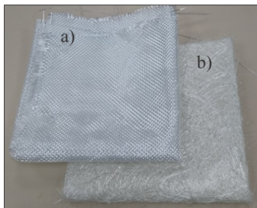
Figura 20 - Reforços utilizados. a) Tecido de trama plana de 330\text{g/m}^2 e b) Manta de 300\text{g/m}^2 .
