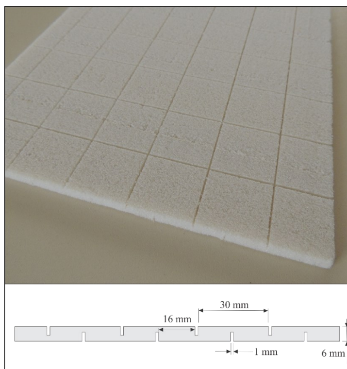
Figura 21 - Núcleo de PET utilizado e dimensões das ranhuras.
