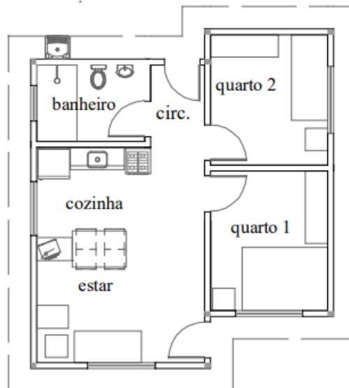
Figura 2 – Caso base: Planta baixa edificação unifamiliar térrea
