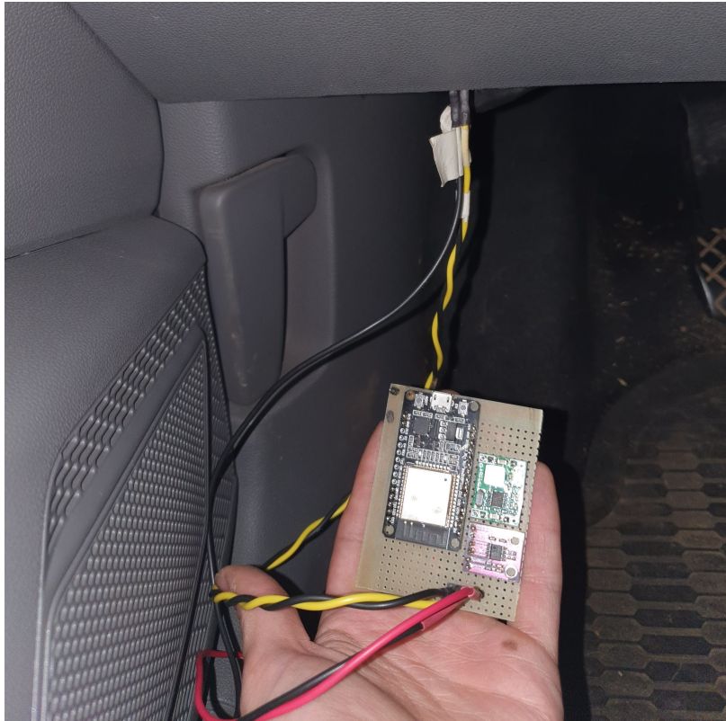
Figura 17 – Protoboard conectada a porta OBD2 do veículo
