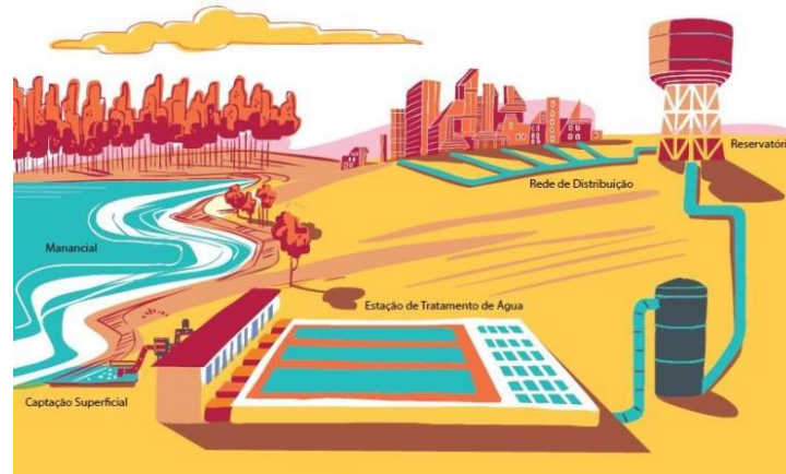
Figura 2– Esquema do Sistema de Abastecimento de Água.
