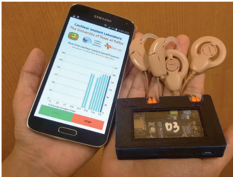
Figura 50 – Fotografia da plataforma de pesquisas em ICs conectada via Wi-Fi a um smartphone , que funciona como processador. A estratégia de codificação do som é programada como um aplicativo no telefone. Fonte: Hazrati et al. (2016)
