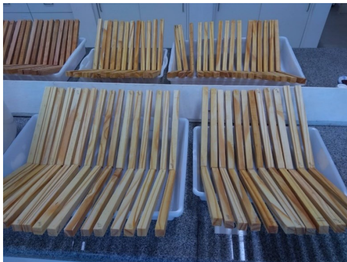
Figura 5 – Exposição dos corpos de prova em temperatura ambiente, para a secagem após tratamento.
