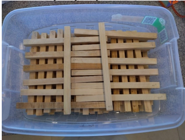
Figura 3 – Disposição das estacas para que haja uma melhor absorção da solução.
