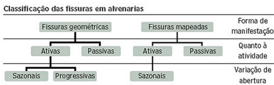
Figura 02 - Classificação das fissuras em alvenarias
